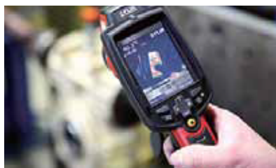
减速箱运行时的热图像检测
