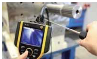
不用拆卸减速箱诊断过程中
